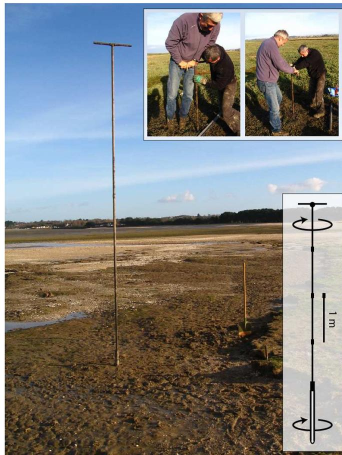
**Figure II.5 : Dispositif du carottier.**
