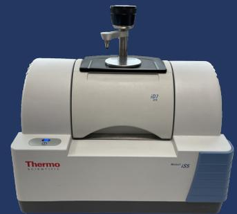
Spectromètre infrarouge ATR
