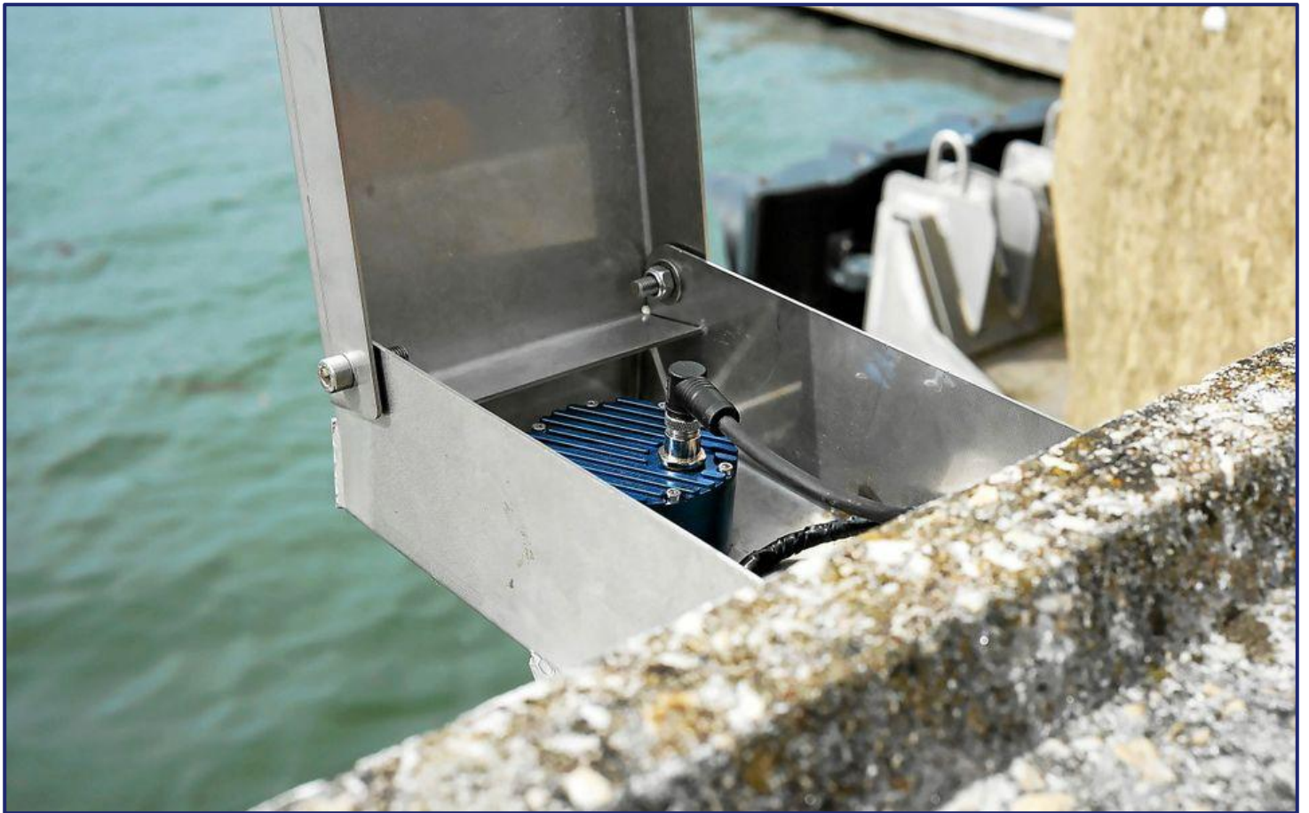
Un marégraphe a été installé courant juillet au pont du Kérino, à Vannes (Morbihan) dans le but de prévenir les inondations et les submersions. (Le Télégramme/Donatien Compeyron)
